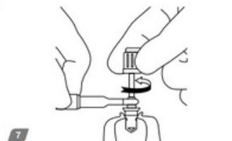
7 Después de colocar el implante, retire la montura con la llave fija (01-CH10) y el destornillador (02-EG20).
