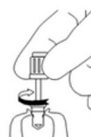
8 Prelevare la vite di copertura dal tappo della fila e avvitare sull'impianto mediante il Cacciavite.
